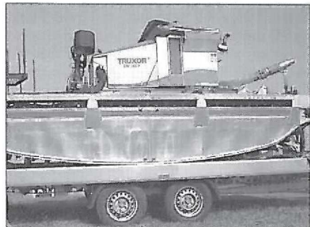
A TRUXOR úszómunkagép legújabb típusa szárazon...
